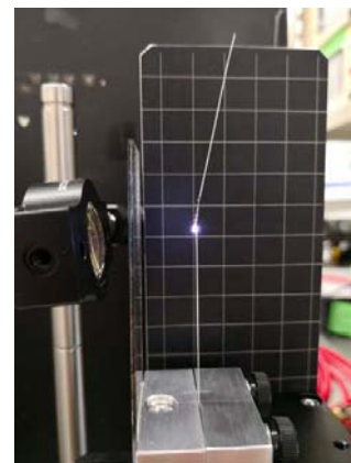
図3 マイクロレーザーによるピーン・フォーミング
