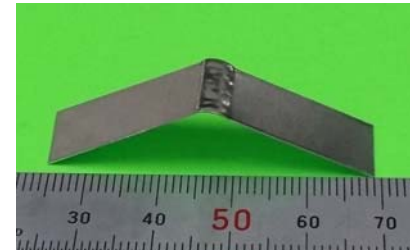
純アルミ t=0.3\text{mm} E=30\text{mJ} の外観
