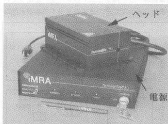
写真1 超小型・高安定フェムト秒ファイバーレーザー (イムラアメリカ社、フェムトライト、1560nm、150fsec、60mW、及び780nm出力)
