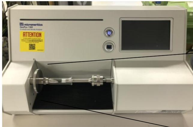
圧粉体など水中に浸漬できない試料については、シリンダー中に試料と平均粒径120umの疑似流体（DRYFLO™）を充填し、疑似流体の量から試料の体積(かさ)を見積もる
