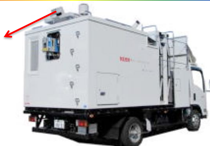
レーザースキャナーによる検査
