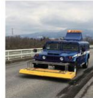
車載型高速スキャンレーザーによる床版内部の診断
