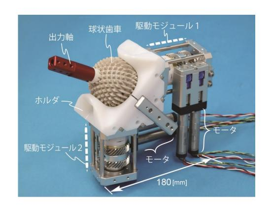
合計4個のモータで、一点で直交する 回転3自由度を実現している。
