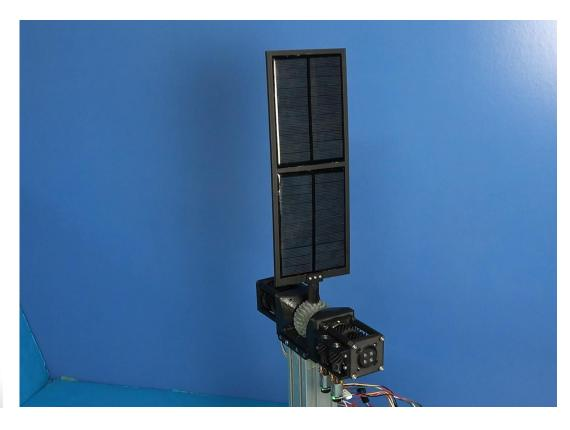
球状歯車をドローンのカメラおよび人工衛星の太陽電池パネルの「首振り機構」やロボットアームの「関節」に応用してゆく。
