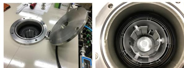
炉内には上部からアクセス、熱シールド (リフレクタ) はモリブデン製、ヒーターはクリーンなタングステン製 (メタル炉はコンタミが出ないがカーボン炉に比べ高価)
