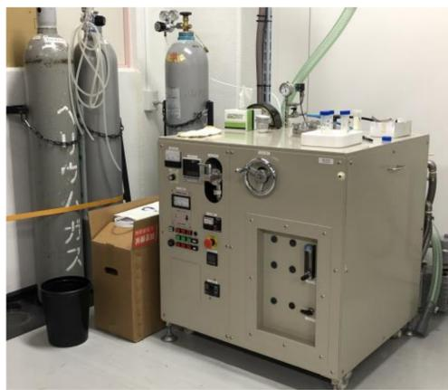
超高温真空・雰囲気炉 (TSM-050-ST、アクティブ)
