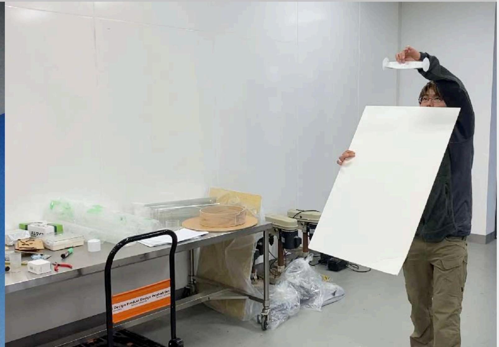
FOLLOW WHEELの飛行体ボディには、当初発泡スチロールを0.5mm厚に薄くカットした材を使用
