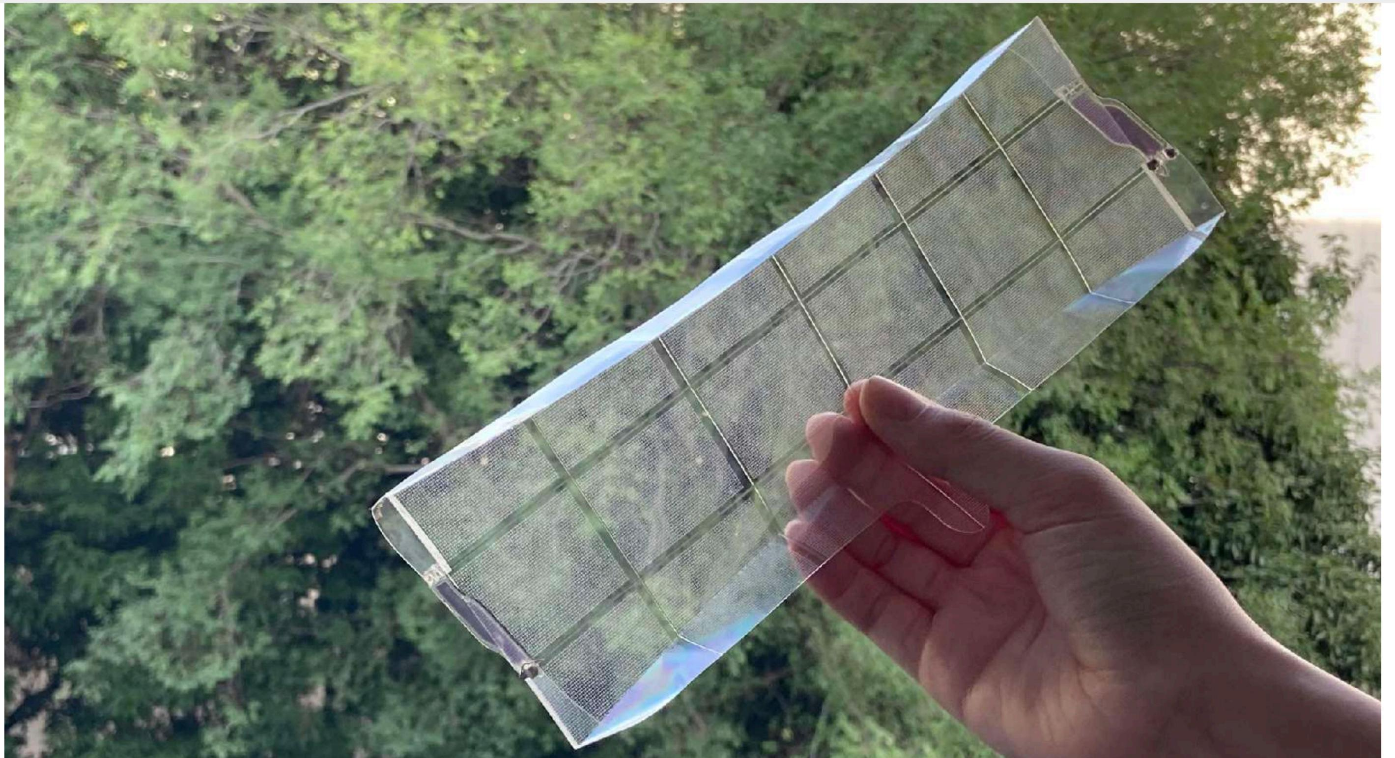
省電力 or 電池レスで色が変わる Electrochromic device の特性を活かして飛行体をつくる
