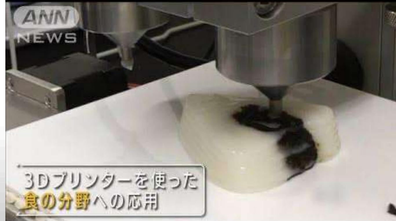
様々な分野で導入が進む3D PRINTER技術は食の分野にも進出。**人工肉を形成する技術も実用化。**植物由来の成分を細い繊維のように出力して重ね、動物の肉に近い食感や外見を再現している。3Dプリンターがレストランに納入され、現場で肉を出力してつくることも可能になる。嚥下への対応など、**個々の高齢者の状態に合わせた硬さの調合も可能になる。**3Dプリンターで使用される注入用のペーストは保存が効くため、**フードロス削減にも期待大。**
