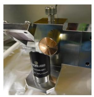
銅筒に石英管を取り付けるように変更。
